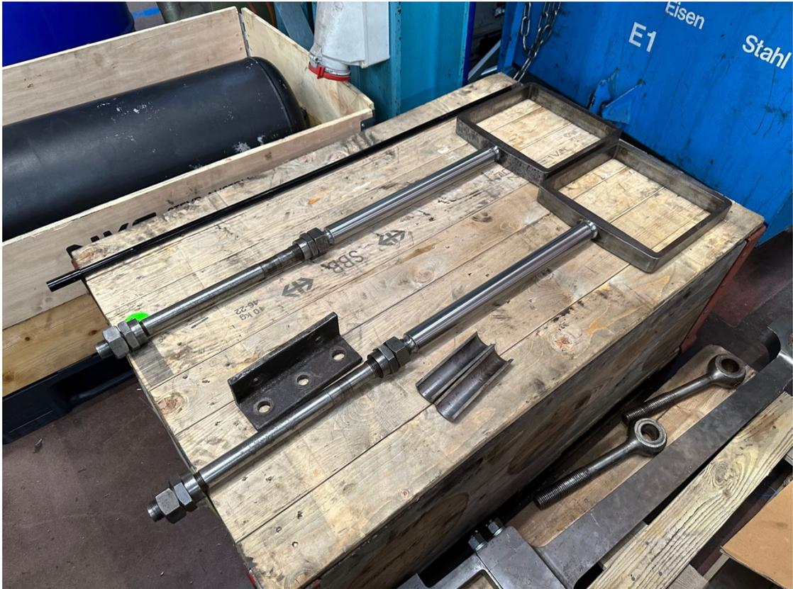
Der grundierte Topf ist der Vakuumpuff für den Abdampf der Vakuumbremse.
