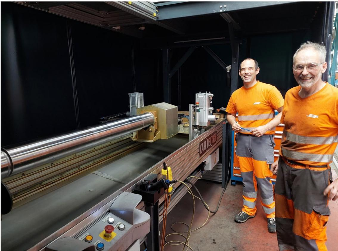
Die Radsatzwelle wird Ultraschall geprüft
