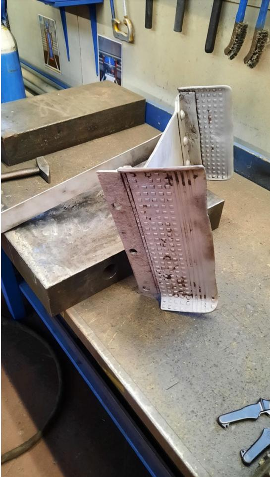
Der Tritt ist am Werkzeugkasten angepasst und verschraubt
