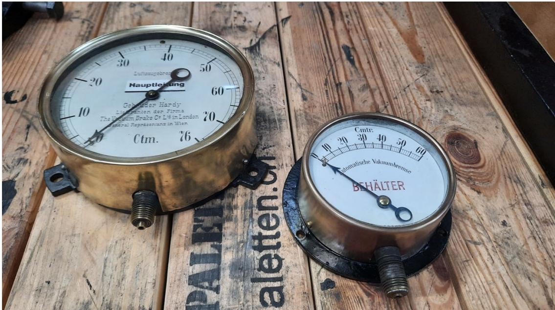
Der Kesseldruck Manometer ist ebenfalls revidiert
