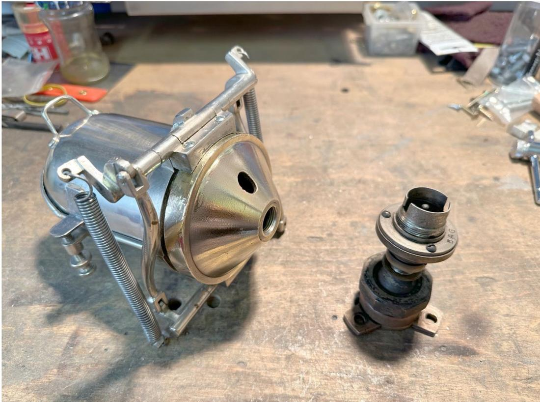
Links die Halterung die am Dach angeschraubt wird, Mitte und rechts die innere Fassung für die Birne
