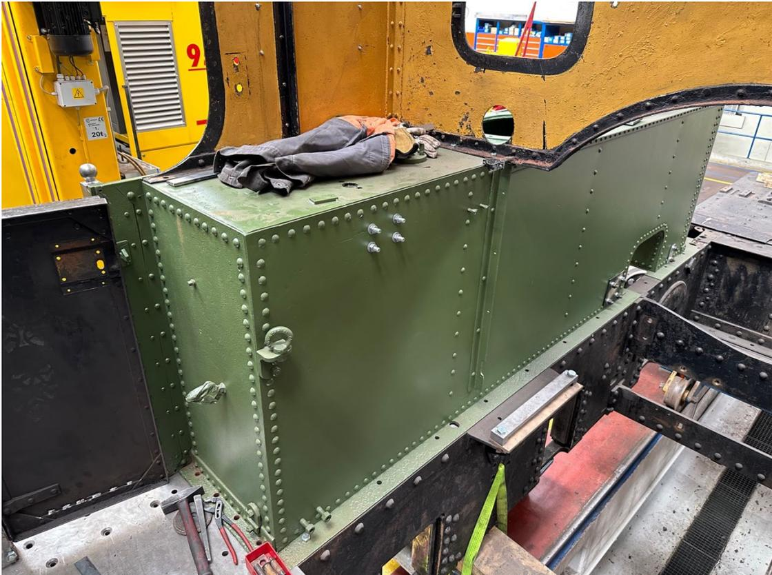
Der rechte Wasserkasten ist kürzer, da bei der Aussparung der Steuerbock eingebaut wird
