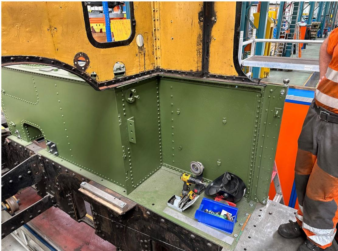
Die Führerhaus Vorderwand mit den Fensteröffnungen. Es müssen diverse Bohrungen zugeschweisst werden. Das Dach muss neu angefertigt werden, da die Bleche und die inneren Bretter alle verfault waren
