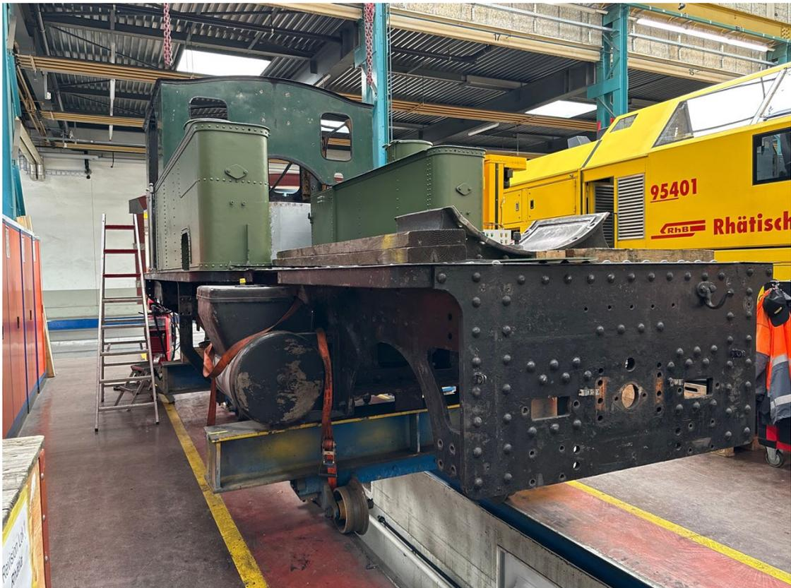
An der Kesselabstützung sind die rostigen Teile ersetzt worden
