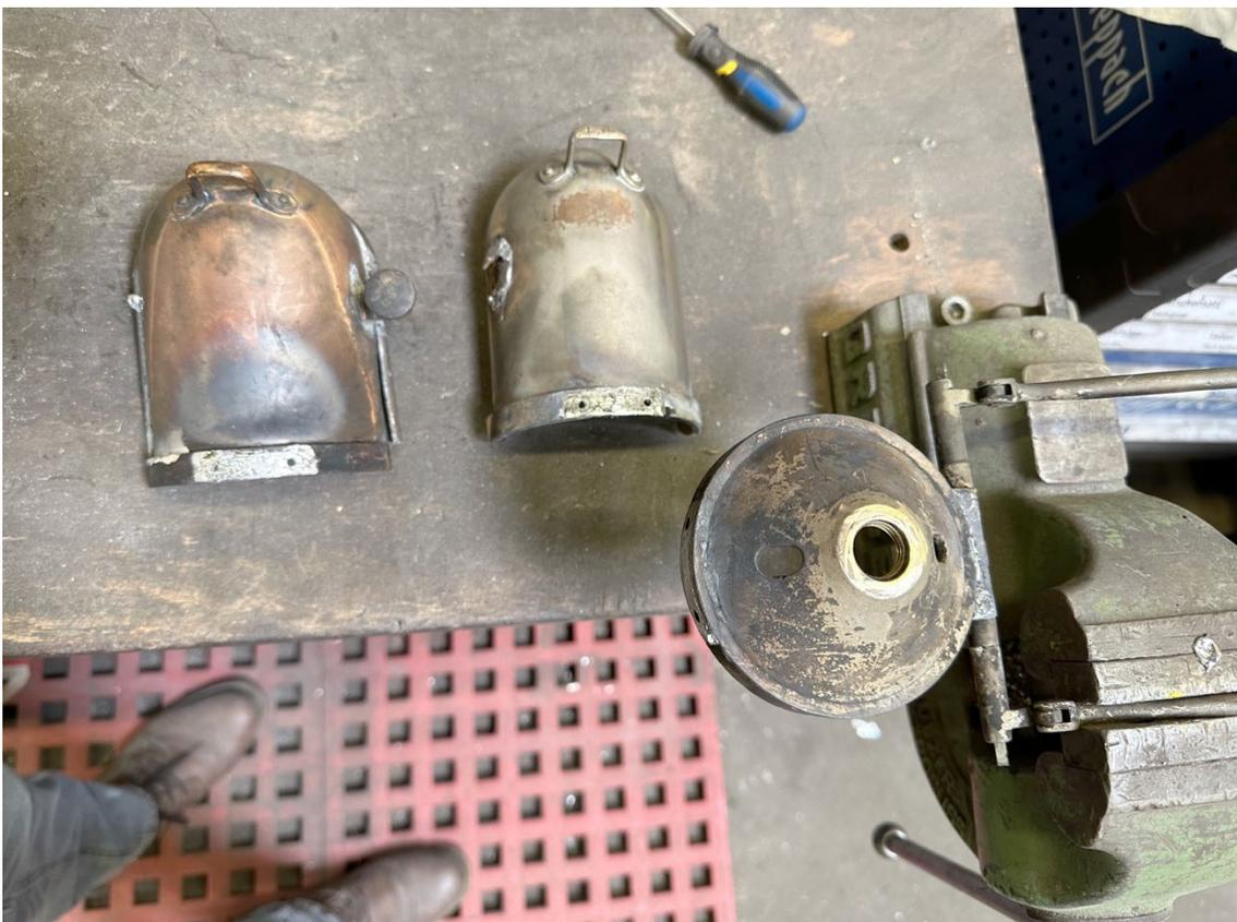
An der Lampe wurde der obere Teil entfernt und dann wird der polierte Teil der Lok 1 oben angeschraubt und schon war die Lampe wieder perfekt
