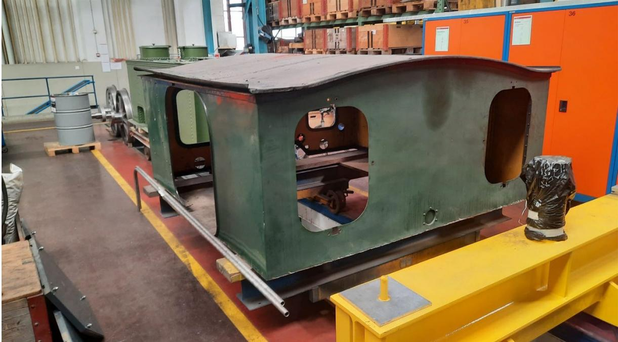
Führerhaus, Wasserkasten und zwei Achsen
