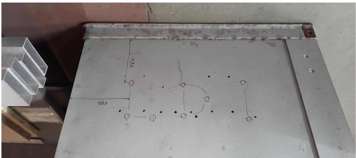
Der Kohlenkasten Boden musste ersetzt werden
