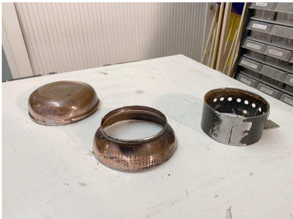
Links die Steckdose für die LED-Birne, Mitte der Kosmosbrenner und rechts der Kosmos Zylinder. Vorne die Seitenwände für den Imitations Öl Becher
