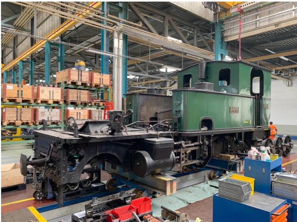
Vorne der Dampfgenerator, in der Mitte die Steuerwelle
