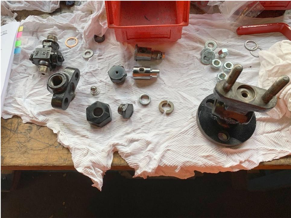
Markus Kick beim Zusammenbauen des unteren Absperrhahnes des Wasserstandes
