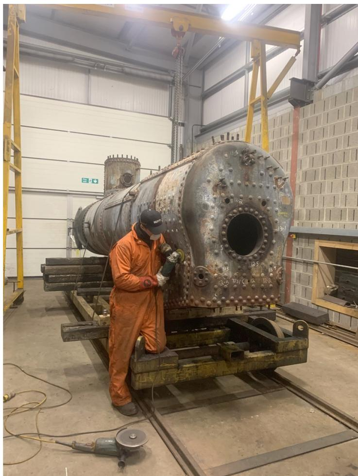
Mit der Trennscheibe werden die Köpfe der Stehbolzen weggeschliffen
