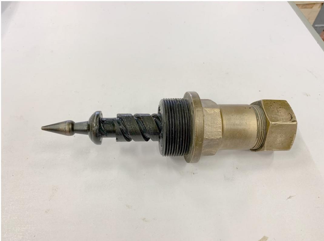
Die Düse mit der Verschraubung
