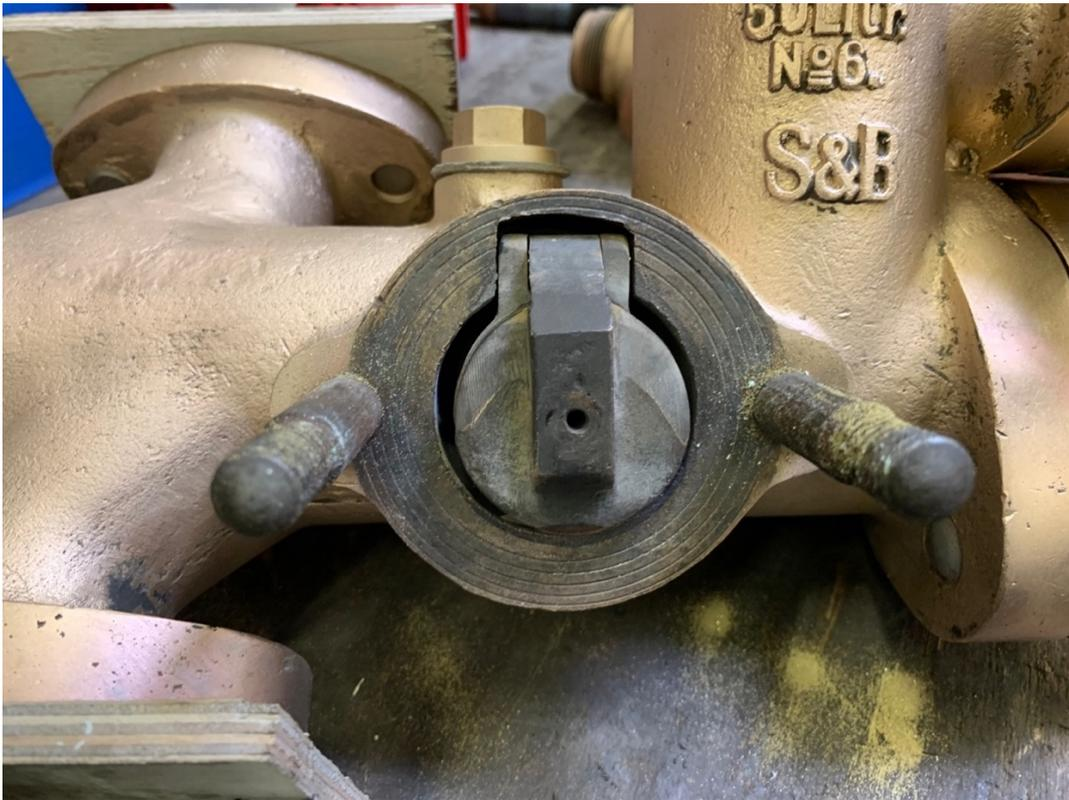
Mit dieser Düse wird ein Vakuum erzeugt und das Wasser angesaugt
