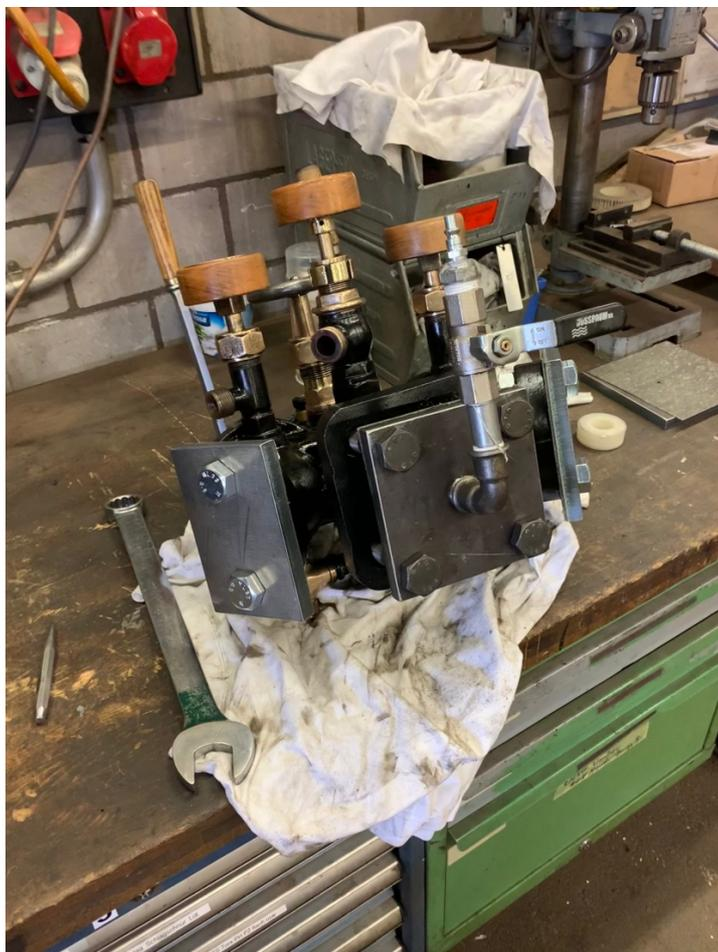
Der nächste Schritt ist, 10 bar Luft in den Armaturenstock einlassen, um die Dichtigkeit zu Prüfen
